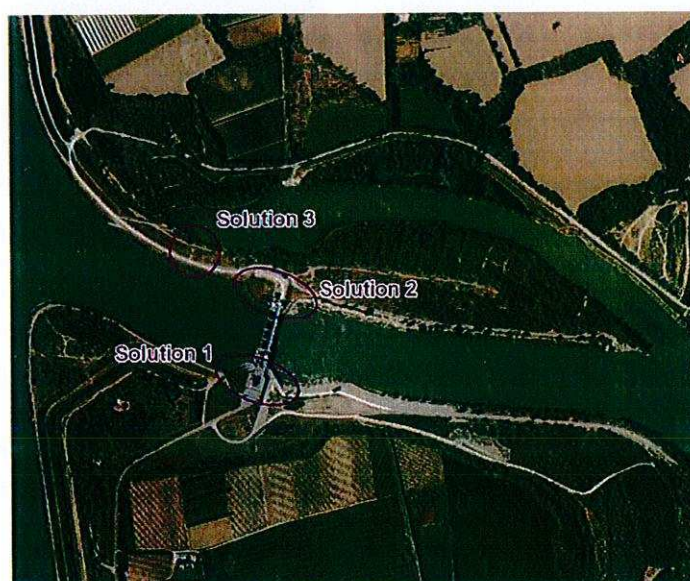
Illustration 8 : Implantations envisagées de l'ouvrage de franchissement
